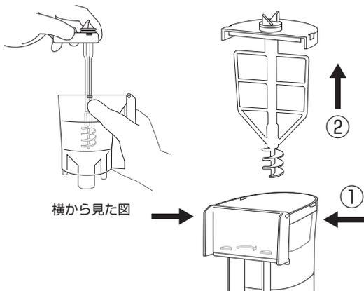
キャニスタのフタ部分を開け、左図のキャニスタの側面部分を同時に押して、キャニスタの軸部分を引き抜いて外してください。
