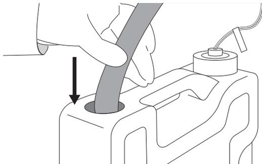
排水タンクのキャップを締めてコネクタを接続し、排水チューブを差し込んでキャビネットに戻してください。
