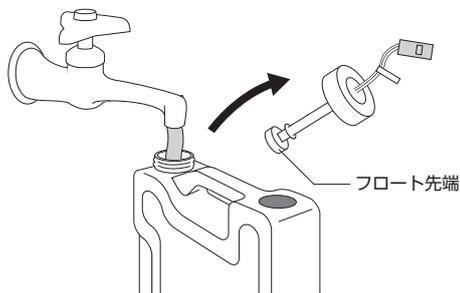
排水タンクのキャップを外して中の水を捨てた後、排水タンク内及びフロートの先端を水で濯いでください。
