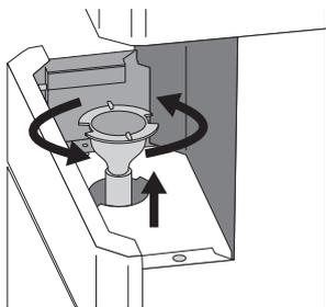
排水ロートを反時計回り回転させて、排水チューブがついたまま真上に引き抜いてください。
